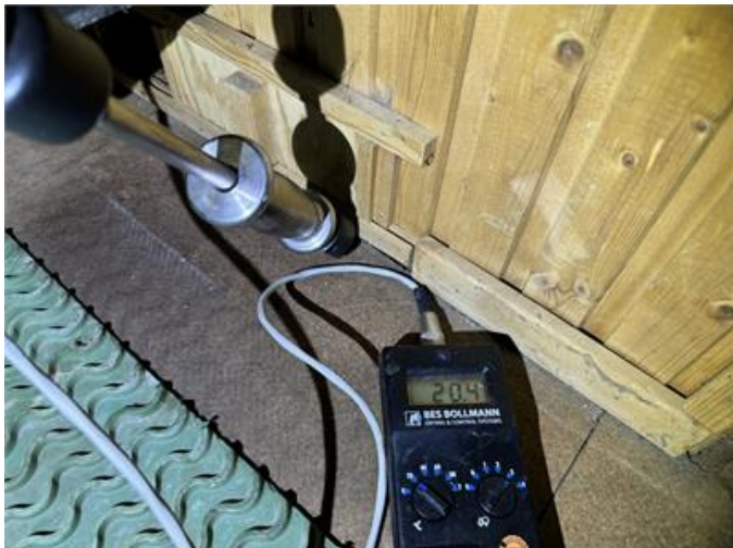
Fuktkvotsmätning i "bastugolv"
