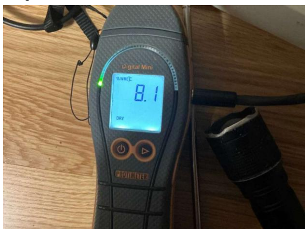
Bild 9: Invändigt, Källarplan, Fuktkontroll utförd under gränsvärde se bilaga 4
