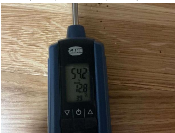
Bild 10: Invändigt, Källarplan, Fuktkontroll utförd under gränsvärde se bilaga 4
