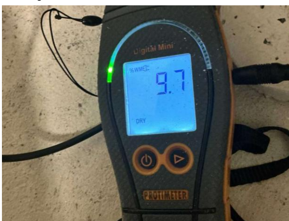
Bild 12: - Invändigt, Källarplan, Fuktkontroll utförd under gränsvärde se bilaga 44
