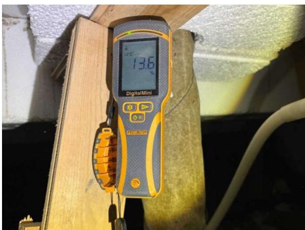
Bild 5: - Utvändigt, Grund, Krypgrund betongbjälklag med uppreglade golv, se riskanalys Fukttavvisande plastfolie saknas på kr...
