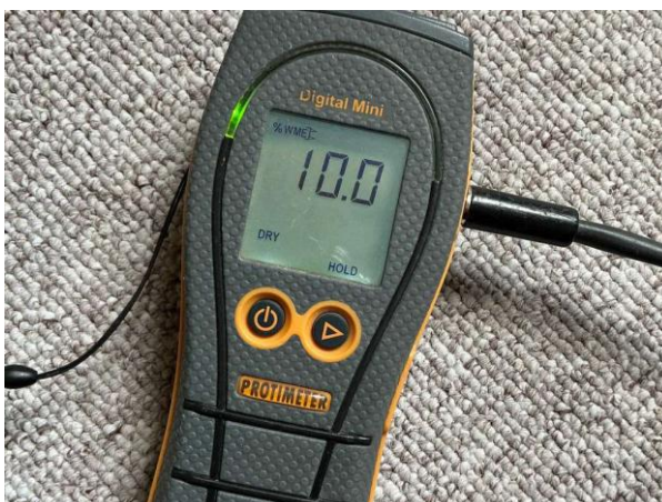
Bild 6: Invändigt, Entréplan, Fuktkontroll utförd under gränsvärde se bilaga 4
