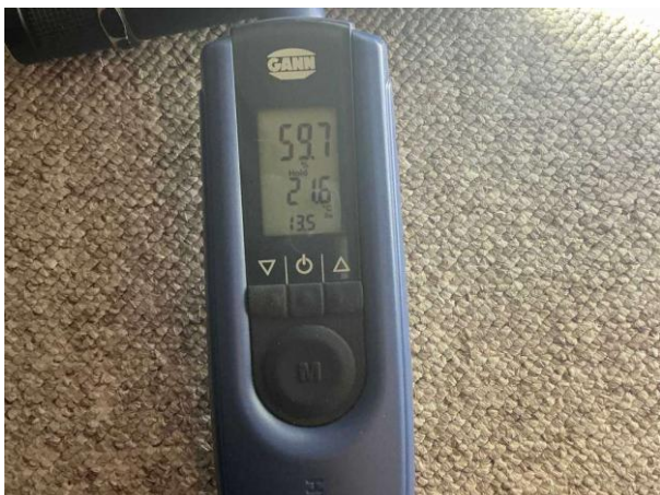
Bild 3: - Invändigt, Entréplan, - Fuktkontroll utförd under gränsvärde se bilaga 4
