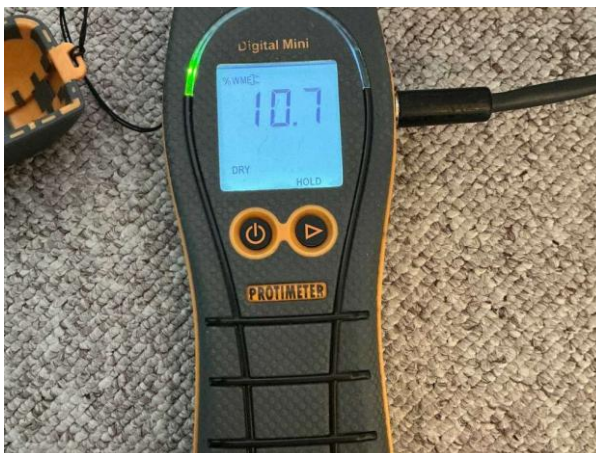
Bild 4: - Invändigt, Entréplan, - Fuktkontroll utförd under gränsvärde se bilaga 4
