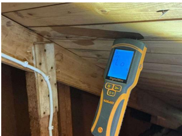
Bild 1: - Invändigt, Övervakning, Lokal mikrobiell påväxt på underlagstaket. Se riskanalys vid inga förhöjda fuktvärden noterades.
