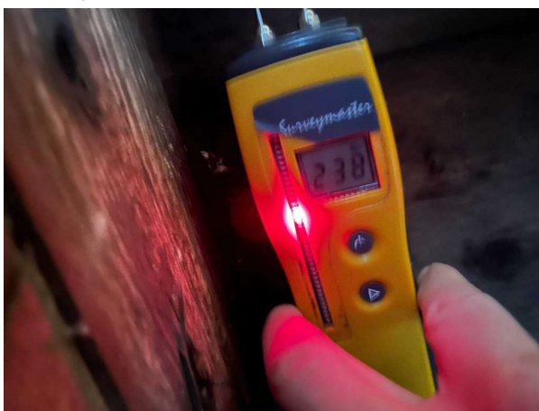
Bild 6: Utvändigt, Vind, Fuktfläckar noteras på insida yttertak. Vid stickprovskontroll med fuktindikator noteras förhöjda...
