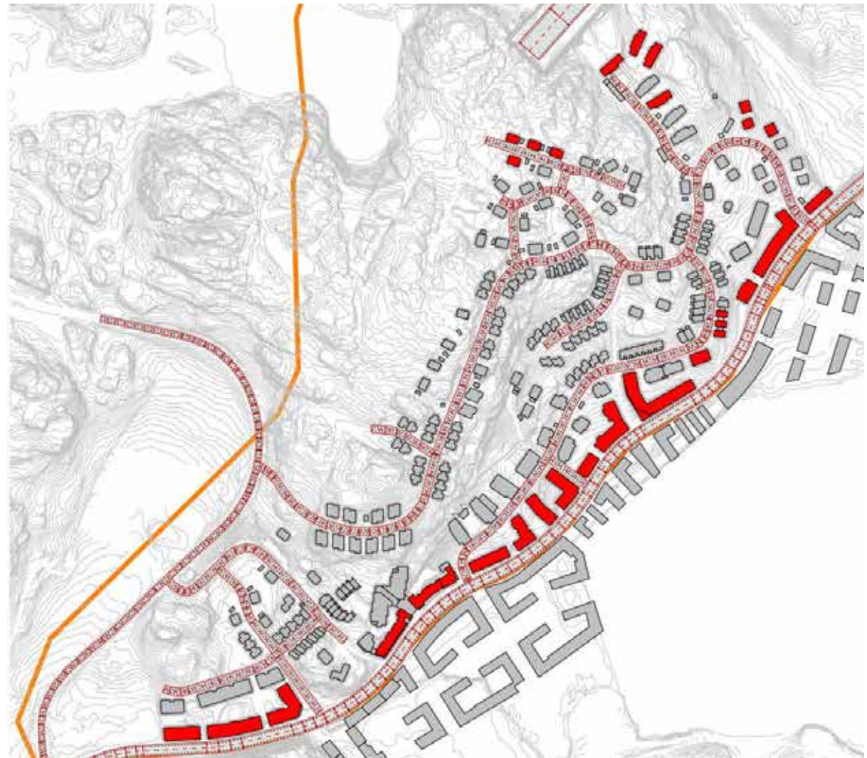
Byggnader med fasadnivåer över 55 dB(A).
